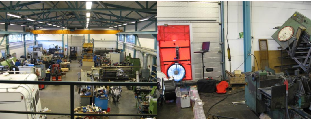
Kuva 4 v. 2009 mitatun (2004 valmistunut) 599 m 2 hallin ilmavuotoluku n 50 oli 0,7 1/h. /3/
